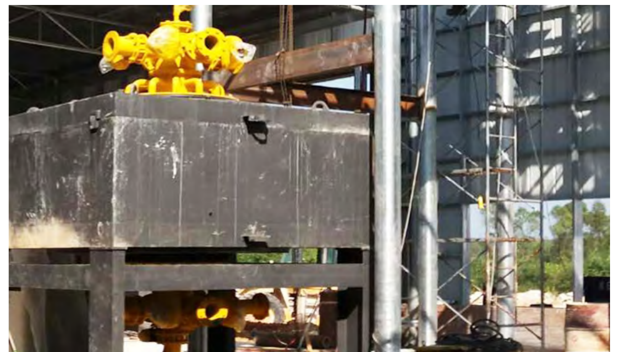
SJ型浆料高梯度磁选机在广西合浦分选石英砂
