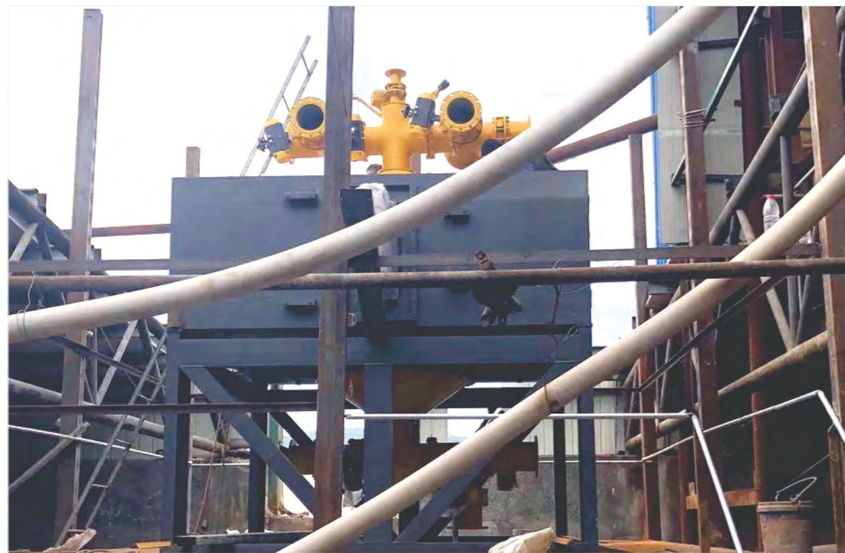
SJ型浆料高梯度磁选机在辽宁本溪分选石英砂
