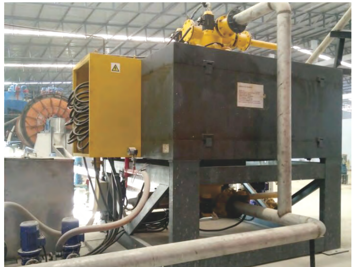
SJ型浆料高梯度磁选机在印度分选长石矿
